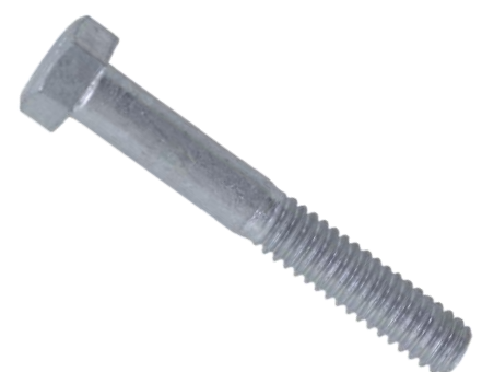
Bolt Grade 4.8 HDG DIN 601
